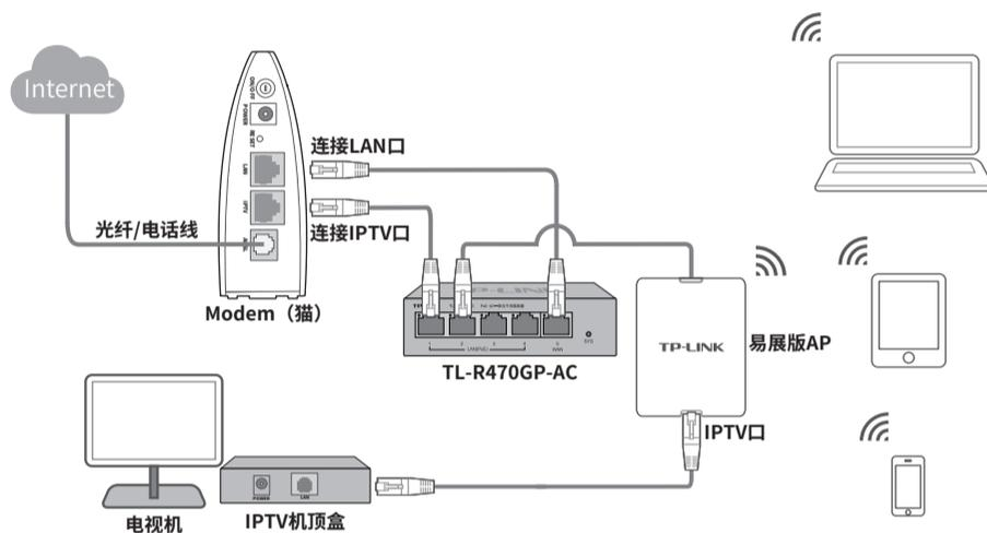
3 按照如上步骤和示意图将设备连接完好之后, 将易展AP的FAT/FIT模式开关拨到FIT模式(如下图所示), 并确认AP已正常上电。
